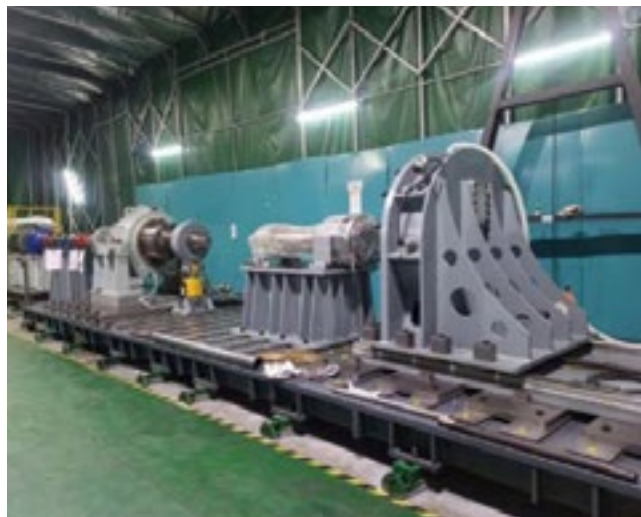
适用中间轴承、水润滑轴承、艏轴密封、隔舱密封、侧推密封装置
